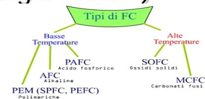
**Tipologie di Celle:** si distinguono in base **all'Elettrolita impiegato** e **T° funzionamento**
