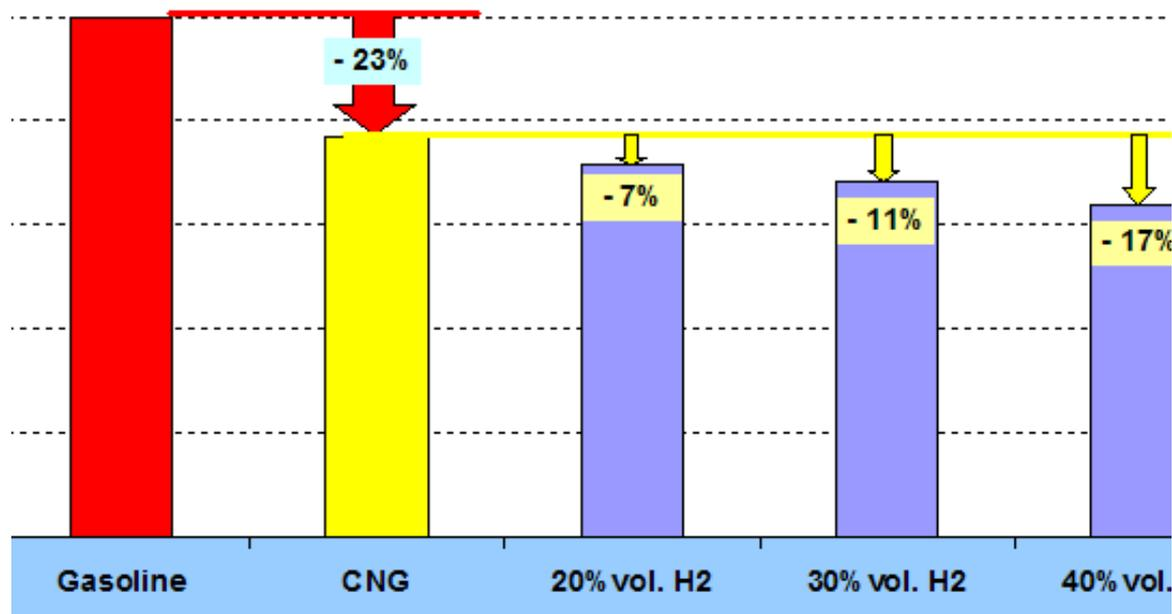
L'utilizzo della miscela al 30% in volume di idrogeno consente un'immediata riduzione della CO2 allo scarico dell'11% rispetto al solo metano (-34% rispetto alla benzina)
