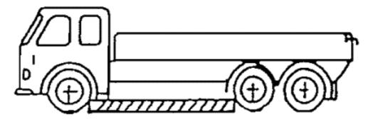
4.5.2. Per «altezza minima dal suolo di un asse» si intende la distanza misurata dal punto più alto di un arco di circonferenza che passa per il centro della superficie di appoggio delle ruote di un asse (delle ruote interne nel caso di pneumatici gemellati) e tocca il punto fisso più basso del veicolo tra le ruote.
