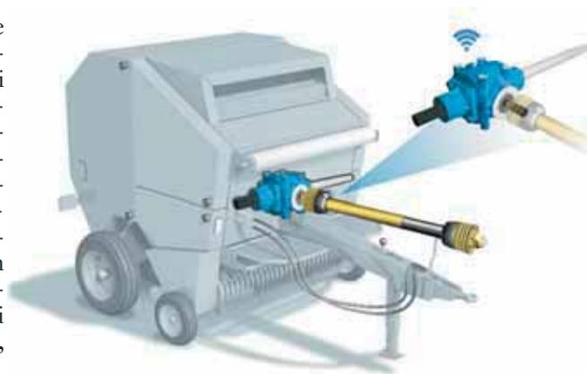
Schema sensore per misurare la temperatura dell'olio di una scatola ingranaggi
